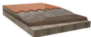
MORTERO DE RELLENO (HORMIGÓN LIGERO)
