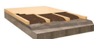
LLENADO DE LA CÁMARA DEL PISO
