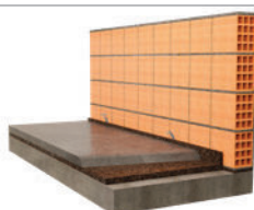
DESACOPLAMIENTO DEL MORTERO DE RELLENO A LA PARED
